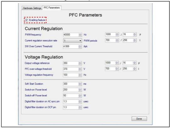
Figure 36: PFC parameters
